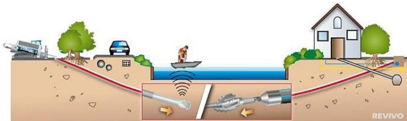
Figură 28 Schema de realizare a forajelor orizontale dirijate
